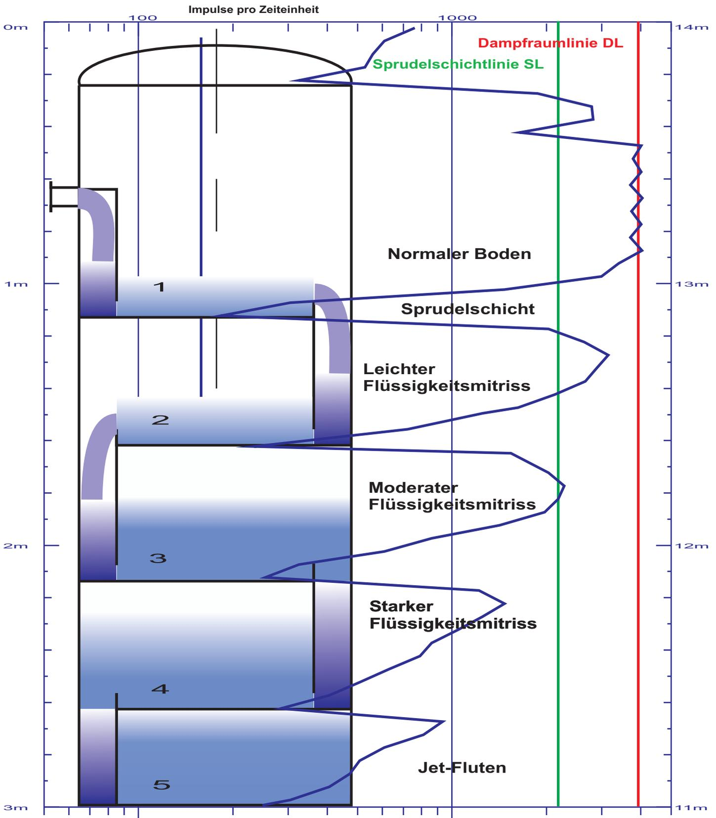
Der Grad des Flüssigkeitsmitrisses ist eine Funktion der Dichteunterschiede Flüssigkeit / Gas, Viskosität, Oberflächenspannung und Gasgeschwindigkeit.
